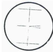
Figura 3. La figura muestra la disposición de la cruz filar sobre la lente del enfoque de un equiatímetro.
