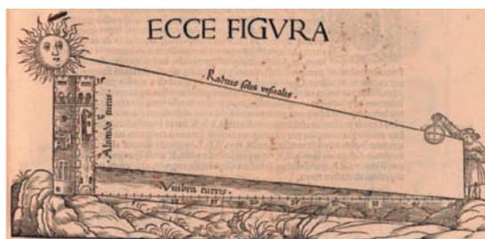
Figura 6. Imagen de la técnica de medición cuando la elevación del Sol es menor a  $45^\circ$ , tomada de “*Elucidatio Fabricae Ususque Astrolabii*”, por Stöffler, 1513, segunda parte, folio LXXI
